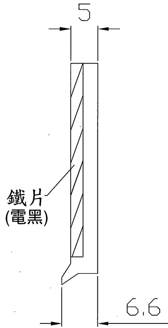
新型刮刷片高度型狀皆可訂製
