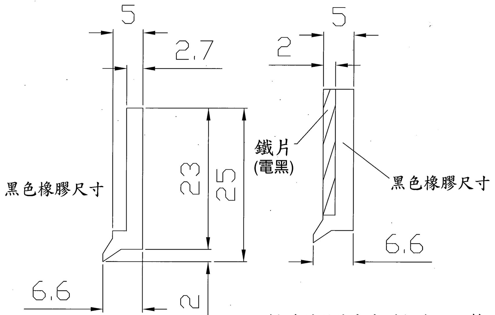
新型刮刷片高度型狀皆可訂製
